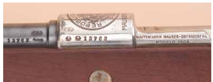
Hülse des M 1909 von links mit Abnahme- und Beschuss-Stempeln, Seriennummer sowie Firmen- und Modell-Bezeichnung.
