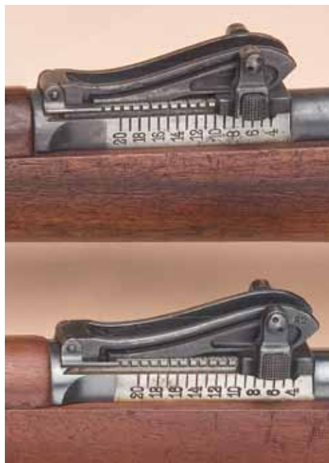
Aufwendig: Die Lange-Visierung begann bei 400 m. Sie war für den Bewegungskrieg gedacht.
