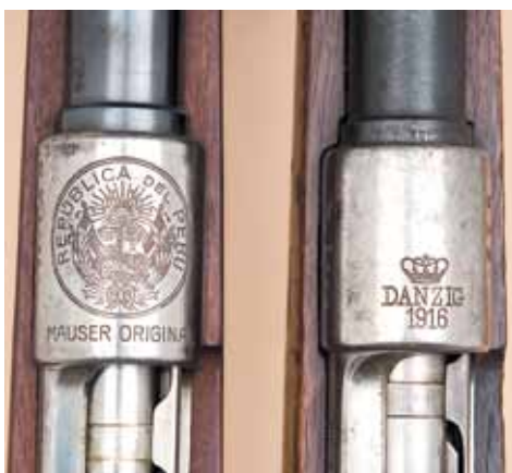
Vorderer Hülsenbereich des M 1909 und des deutschen Gewehrs 98 im Vergleich.
