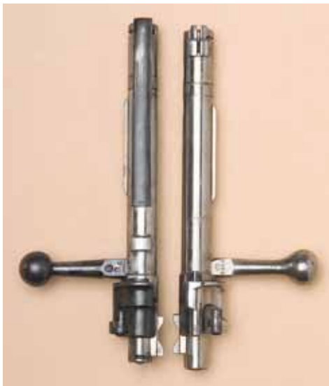
Schlosse des deutschen Gewehres 98 und des peruanischen Modells 1909 nebeneinander. Deutlich sind die unterschiedlichen Bemaßungen zu erkennen.
