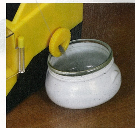
Ablaufventil. Im geöffnetem Zustand strömt das Pulver aus dem Vorratsbehälter heraus.
