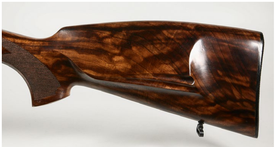
Dekorativer Hinterschaft mit Schweinsrücken und bayerischer Backe – die Holz-„Maserung“ wurde mit einem Laser künstlich erzeugt.
