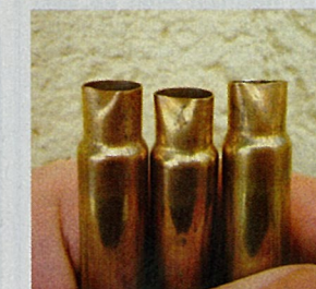
Durch Transporteinwirkung auf die lose Sammelverpackung sind Hülsenmundverformungen nicht auszuschließen.
