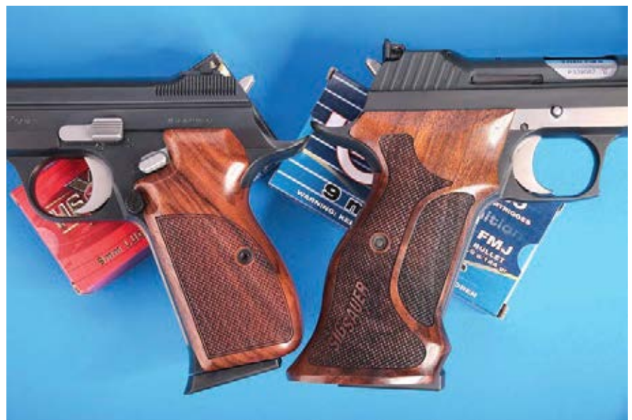
Die Griffstücke von P210 Legend (l.) und der Supertarget: Beide liegen gut in der Hand. Die Nill-Griffschalen der Supertarget eignen sich auch für große Hände.
