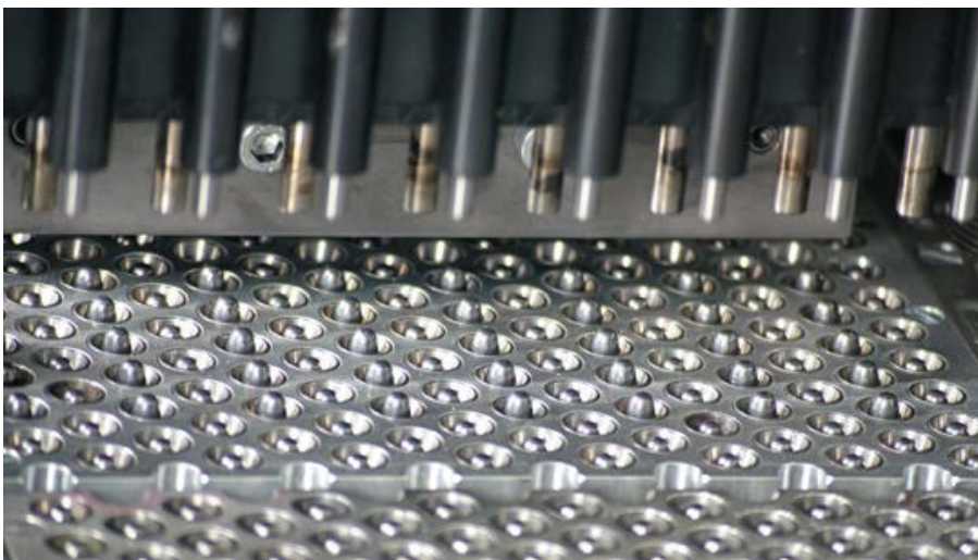
Ein Blick in die Fertigung der Firma RUAG/RWS. Hier werden mittels Laderingplatten die Geschosse auf die zuvor gefüllten Hülsen gesetzt.
