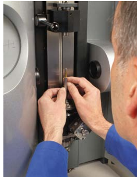
Mit dem „Tesa-Scan 25“-Profil-Projektor können die Patronen mittels „berührungslosem Messen“ auf ihre Form kontrolliert werden.
