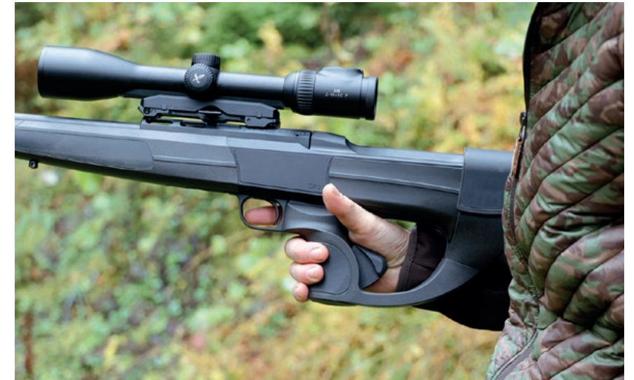
Der Handballenspanner muss zur Schussabgabe fest und tief eingedrückt werden, damit eine Schussauslösung erfolgen kann. Das Entspannen kann man dafür nicht vergessen.
