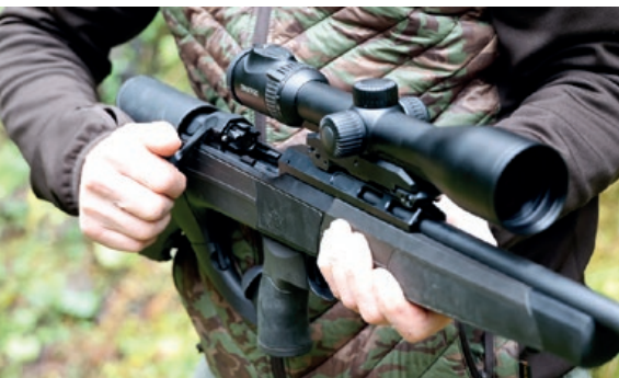
Das Schließen des Geradezugverschlusses muss schwungvoll mit dem Kammerstängel erfolgen, dieser gleitet sauber und weich.
