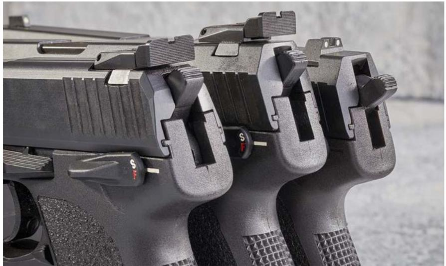
Vorn das in den Verschluss eingelassene LPA-Visier der Expert/Elite. Bei den „Tactical-Modellen (mitte)“ sitzt die LPA-Kimme über dem Schlitten. Ganz hinten die USP-Standardkimme.
