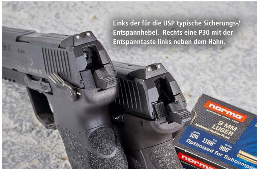
Links der für die USP typische Sicherungs-/Entspannhebel. Rechts eine P30 mit der Entspanntaste links neben dem Hahn.
