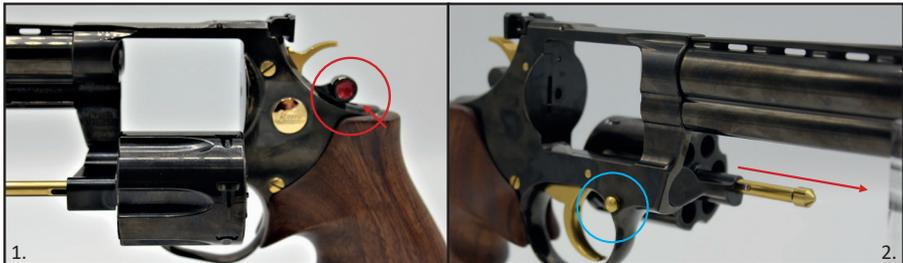
1. Drücken Sie den Entriegelungshebel nach vorne in Richtung Laufmündung, um die Achswelle vom Rahmen zu lösen und die Trommel nach links auszuschnellen (*Hinweis: Die Linksversion wird nach rechts ausgeschwenkt*)
