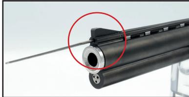
Um einen Korn-Austausch vorzunehmen, muss die M3 Schraube mit einem Innensechskant aus der Laufhülse herausgeschraubt werden. Das Korn kann nun beliebig ausgetauscht werden. (Die verschiedenen Korne sind unter [www.kortharms.com](http://www.kortharms.com) erhältlich)
