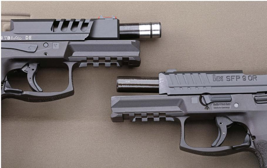
Die Laufmündung ist mit einem O-Ring versehen, der für eine bessere Führung im Verschluss sorgt.
