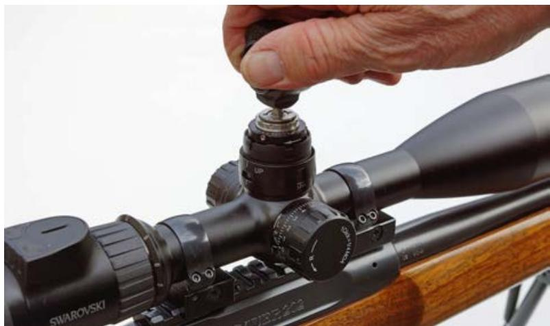
Nach Lösen der drei Madenschrauben des Drehrings am Höhenturm kann eingeschossen werden. Dazu den Inbusschlüssel des Tools in den Turm stecken. Bei Tiefschuss gegen Uhrzeigersinn drehen; bei Hochschuss im Uhrzeigersinn drehen.
