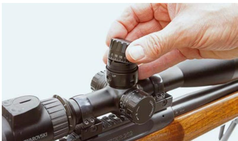
Nach dem vollendeten Einschießen wird das Tool auf den Turm gesteckt und im Uhrzeigersinn gegen den Anschlag gedreht. Festhalten und die drei Madenschraubchen anziehen. Danach wird die Kappe wieder montiert. Alles in allem, eine recht komplexe Arbeit, die man in Ruhe erledigen sollte.
