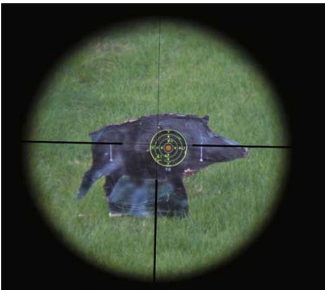
Die 1,7fache Vergrößerung ergibt ein Sehfeld von 12,6 Meter auf einer Entfernung von 50 Metern. Auf gleicher Entfernung sieht man mit 13,3facher Vergrößerung im Vergleich zur 1,7fachen Vergrößerung die Wirkung des 8fachen Zooms.
