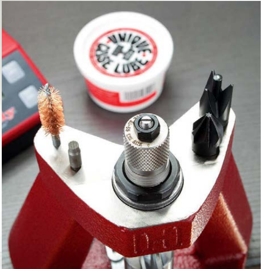
Oben gibt es neben der Matrizenaufnahme Gewindebohrungen zur Befestigung von Reinigungsbürsten und Tools zum Hülsenmundentgraten.
