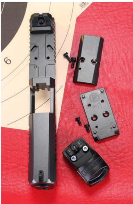
Oberhalb des Auswurffensers werden die Abdeckplatte oder der Adapter angebracht.
