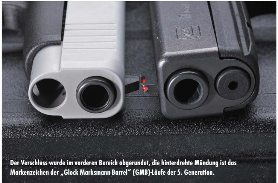
Der Verschluss wurde im vorderen Bereich abgerundet, die hinterdrehte Mündung ist das Markenzeichen der „Glock Marksmann Barrel“ (GMB)-Läufe der 5. Generation.
