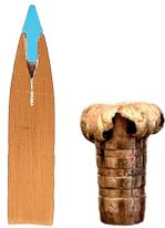
*Vorher und nachher: Das Deformationsgeschoss überzeugte im Test mit hoher Ausschussrate.*
