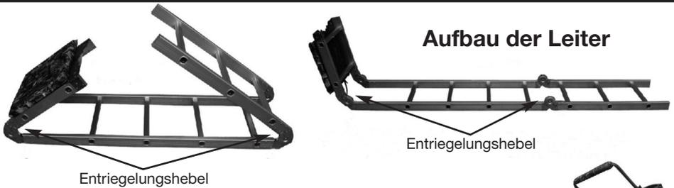
**Schritt 1:** Legen Sie die Leiter auf den Boden und drücken 1 x auf jeden Entriegelungshebel im Gelenk der Ansitzleiter. Jetzt läßt sich die obere Sitzfläche und die untere Leiter anheben und rastet dann ein.
