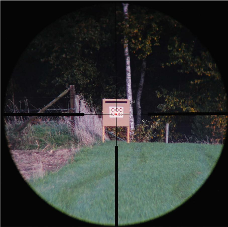
**Falke, Vergrößerung 6x, Entfernung 100 Meter:** Der Leuchtpunkt hat einen Durchmesser von 4 cm und das Sehfeld ist mit 5,3 Meter das kleinste der getesteten Zielfernrohre. Die optische Qualität ist jedoch gut.
