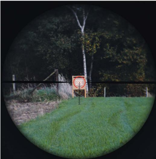
**Kahles K16i, Vergrößerung 6x, Entfernung 100 Meter:** Der Leuchtpunkt hat einen Durchmesser von 3 cm. Die Beleuchtung ist noch lange nicht auf den maximalen Wert eingestellt. Bei sonnenbeschienenem Schnee ist die Beleuchtung bei maximaler Einstellung noch immer deutlich erkennbar. Sehfeld 6,8 Meter.
