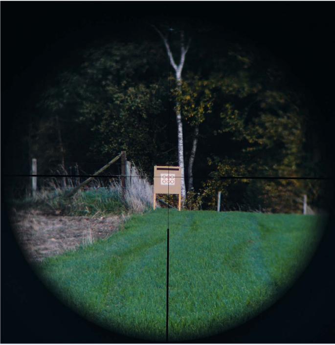
**Leica Fortis, Vergrößerung 6x, Entfernung 100 Meter:** Der Leuchtpunkt hat einen Durchmesser von 2,5 cm und die Fäden des feinen Fadenkreuzes decken nur 0,5 cm ab. Sehr großes Sehfeld von 7,1 Meter.
