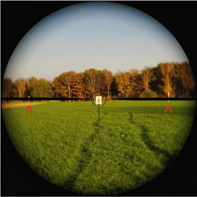
**Kahles K16i, Vergrößerung 1x, Entfernung 50 Meter:** So testeten wir das Sehfeld. Eine Strecke von 15 Metern wurde markiert (siehe rote Pfeile) und der Rest des Sehfeldes bis zum Rand gemessen. Weil Zielfernrohr und Fotoobjektiv nicht aufeinander abgestimmt sind, entsteht Randunschärfe, die es faktisch nicht gibt. Das K16i liefert ein sehr gutes Sehfeld von 21 Meter. Auf 100 Meter sind es 42 Meter!
