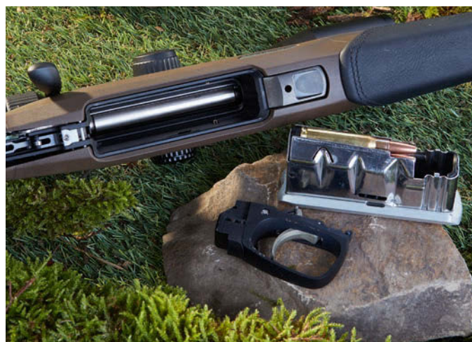
Die Abzugsgruppe lässt sich bei Bedarf mit einem Handgriff entfernen. Rechts: Das Einsteckmagazin für vier Patronen.
