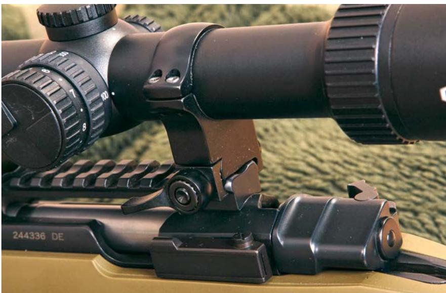
Die Schnellmontage-Ringe des Typs ERA / Recknagel lassen sich über je einen unten am Fuß befindlichen Flügelhebel auf der Pica Rail anbringen repektive davon lösen.
