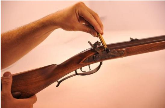
Sollte die Waffe trotz aller Anstrengungen immer noch nicht feuern, **ENTLADEN** Sie diese unter Verwendung des richtigen Kugelziehers (Art.Nr. USA 545). **STELLEN SIE VORHER SICHER, DAS ZÜNDHÜTCHEN ENTFERNT WURDE UND DER HAHN IN DER SICHERHEITSRAST.** Spritzen Sie nun mittels einer Einweg-Spritze o.ä. Wasser in die Schwanzschraube. Wasser löst das Schwarzpulver auf und verhindert dadurch eine Zündung.
