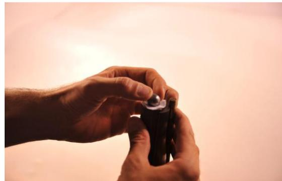
Wir empfehlen dazu die Verwendung eines Kugelstarters (Artikel USA 510) damit die Kugel die ersten 15 cm tief eingeführt wird, danach stoßen Sie sie mit dem Ladestock ganz hinunter.
