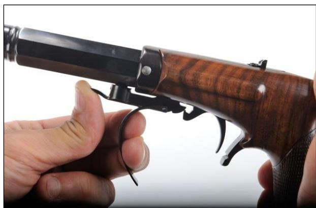
Lösen Sie die Madenschraube Nr. 16 ( FIG. 3 ). Justieren Sie die Einsterllschraube Nr. 15, bis Sie die richtige Position für den Abzug gefunden haben. ( FIG. 4 )
