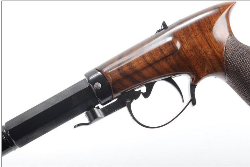
Die Abzugscharakteristik kann durch Einstellung der Madenschraube Nr. 15 (siehe Explosionsdarstellung) verändert werden. Durch Anziehen und oder Lösen dieser Schraube wird die Hahnrast ein- oder ausgerückt, dabei verändert sich auch der Abzugsweg. Um die Schraube Nr. 15 zu sichern ziehen Sie die Madenschraube Nr. 16 an. Aus Sicherheitsgründen, sollte der feste Sitz dieser Schrauben regelmäßig überprüft werden um sicherzustellen, dass sich die Einstellung nicht geändert hat.
