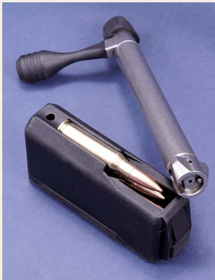
Der typische Sako-Zylinderverschluss der Baureihen M75/85 mit drei Riegelwarzen, die als Dreieck mit abgerundeten Ecken und abgeflachten Seiten ausgebildet sind.
