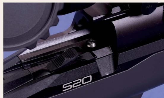
Die Zwei-Positionen-Sicherung mit dem davor gelagerten Bedienelement für die Deaktivierung der Kammerperre bei gesicherter Waffe.
