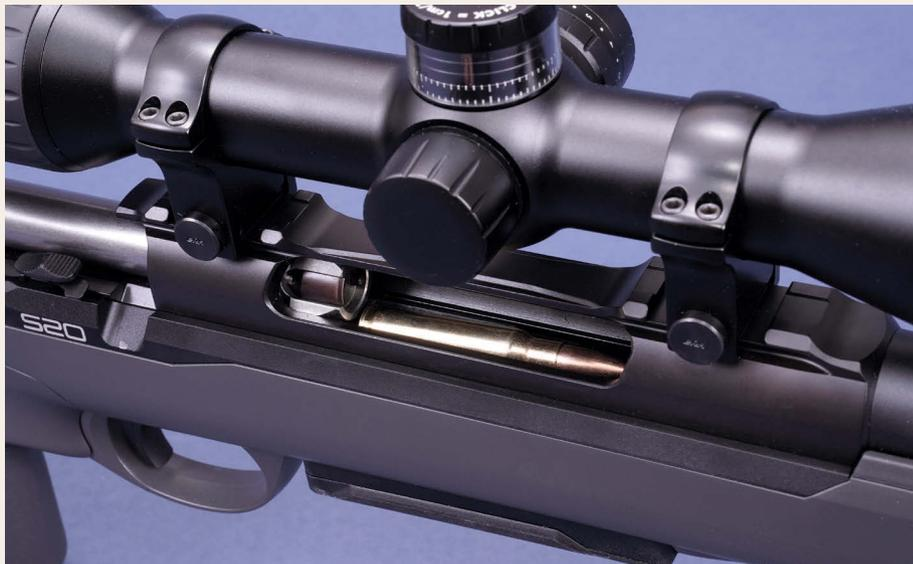
Der Systemkasten ist auch für die Nutzung der langen Magnum-Patronen ausgelegt, was man am 90 mm langen Auswurffenster erkennen kann. Der Repetierweg wurde aber auf die entsprechende Patronenlänge der .308 Win. angepasst und fällt dementsprechend kurz aus.
