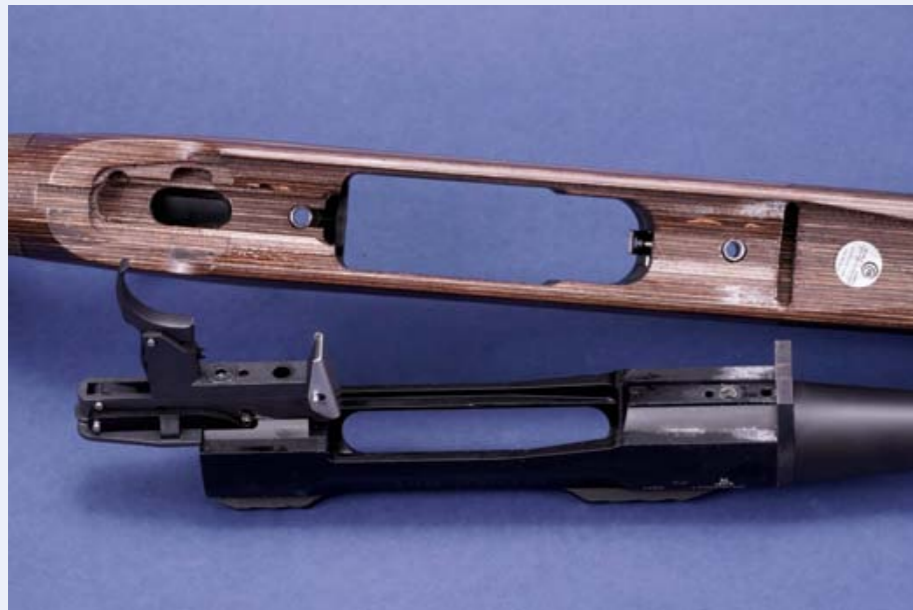
Die Systemschrauben werden im Holzschaff in Metallsäulen geführt, um Verspannungen bei Montage-/Demontagearbeiten zu vermeiden. Das System unserer Testwaffe lagerte mit Minimalspiel im Schaff.
