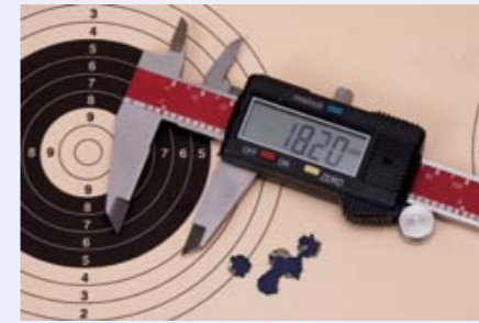
Kann sich sehen lassen: 5-Schuss-Streukreis auf 100 Meter mit RWS Target Elite Plus-Matchmunition.
