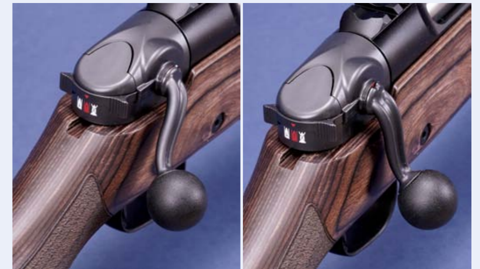
Der „Kickdown“-Kammerstängel übernimmt auch die Funktion des Handspannsystems, hier in entspannter Position (man beachte weiße Markierung an der Kammergriffwurzel) und gespannter Stellung (nun rote Markierung).
