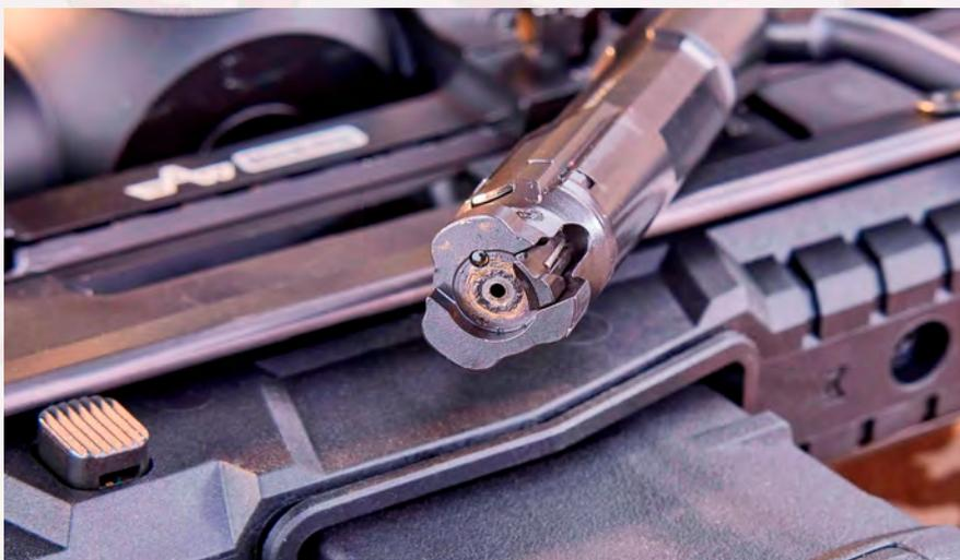
Der Zylinderverschluss der CZ 600 bietet mit seinen drei Verriegelungswarzen einen angenehm kleinen Öffnungswinkel der Kammer.
