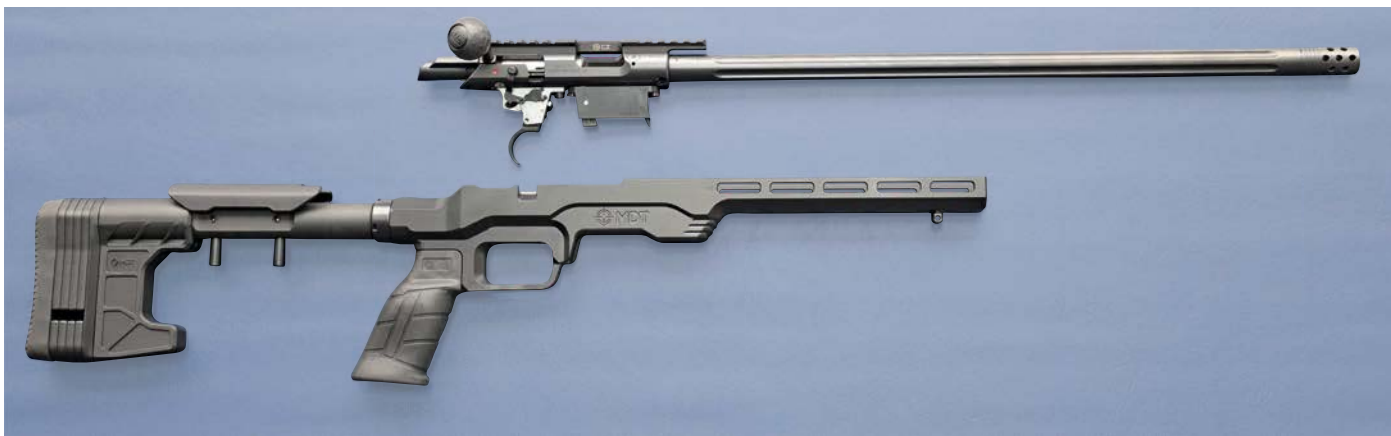
Die teildemontierte CZ 457 MDT zeigte innen wie außen ein ansprechendes Verarbeitungsniveau. Unten ein Blick auf die Systembettung im Leichtmetallträger.
