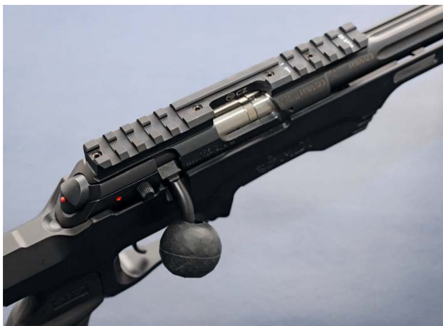
Die vierfach verschraubte, vorgeneigte Montageschiene. Außerdem zu sehen: Ladestandsanzeige und die große Kunststoffkammergriffkugel mit einem Durchmesser von 33 mm.
