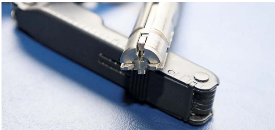
Der kleine Verschluss mit dem doppelten Auszieher und dem Meisel-artigen Schlagbolzen, der die Verwendung von Pufferpatronen überflüssig macht.
