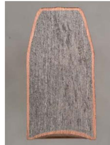
Die Kupferschicht des H&N AccuBull-Geschosses ist mit 250 µm mehr als doppelt so dick wie beim High-Speed-Geschoss. (Foto: Axel Manthei)
