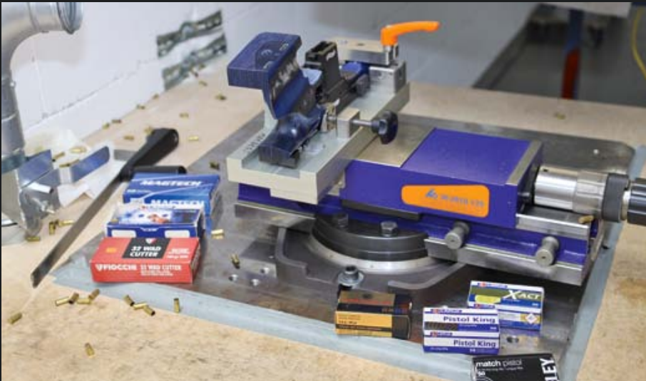
Die Welt steht Kopf: Die GSP 500 in der Einspannvorrichtung für die Präzisionsüberprüfung.
