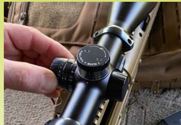
Alle Ranger 8 bieten am linken Turm die Intensitätsregulierung des Leuchtpunktes. Bis auf das 1-8x24 findet sich dort auch der Parallaxeausgleich von 20 m bis Unendlich.
