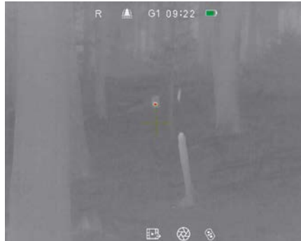
Das Wärmepad erscheint beim Einschießen als leuchtender Wärmepunkt (Entfernung rund 50 m).
