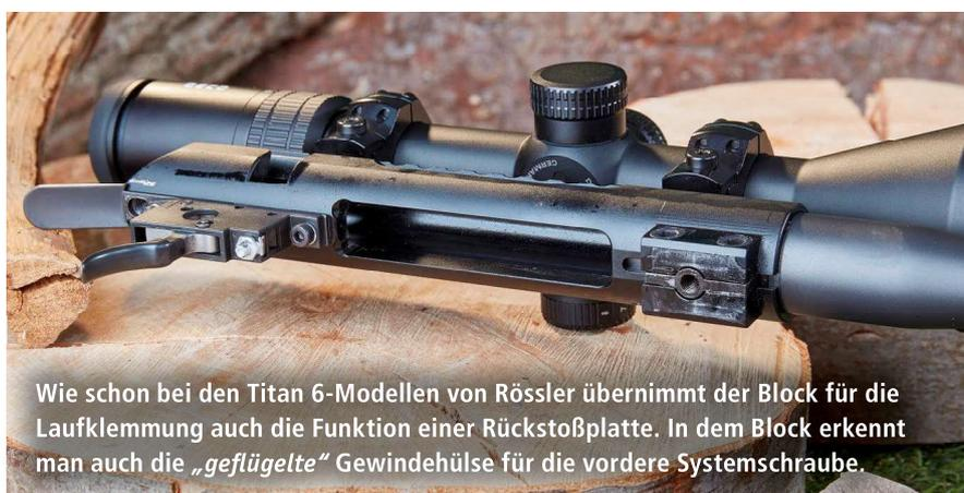
Wie schon bei den Titan 6-Modellen von Rössler übernimmt der Block für die Laufklemmung auch die Funktion einer Rückstoßplatte. In dem Block erkennt man auch die „geflügelte“ Gewindehülse für die vordere Systemschraube.
