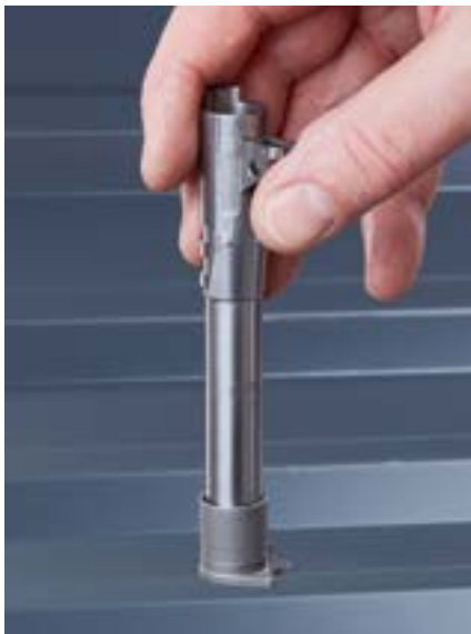
Top: Die Mündungsbuchse der Competition bleibt am ungeöhlten Lauf haften.
