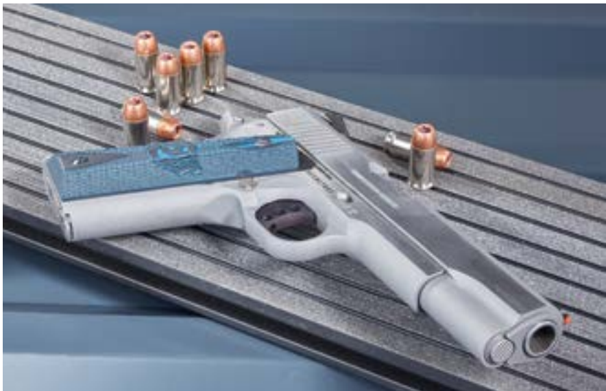
Das Griffstück der Colt Competition ist vorn glatt, auch fehlt der zweite Sicherungsflügel. Aber dafür gibt es einen Triggerstop und eine Mulde für den Mittelfinger.
