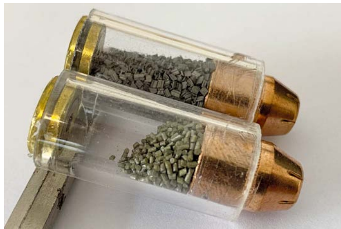
Wie gut das RS 14 die Hülse ausfüllt, lässt sich hier erkennen: 8,0 Grains RS 14 in der hinteren Patrone im Vergleich zu 6,2 Grains Vihtavuori N320 in der vorderen Patrone, die ungefähr die gleiche Leistung liefern. Die Zündflamme erreicht das Pulver gleichmäßiger, dadurch werden Abbrand und Geschwindigkeit stabiler.
