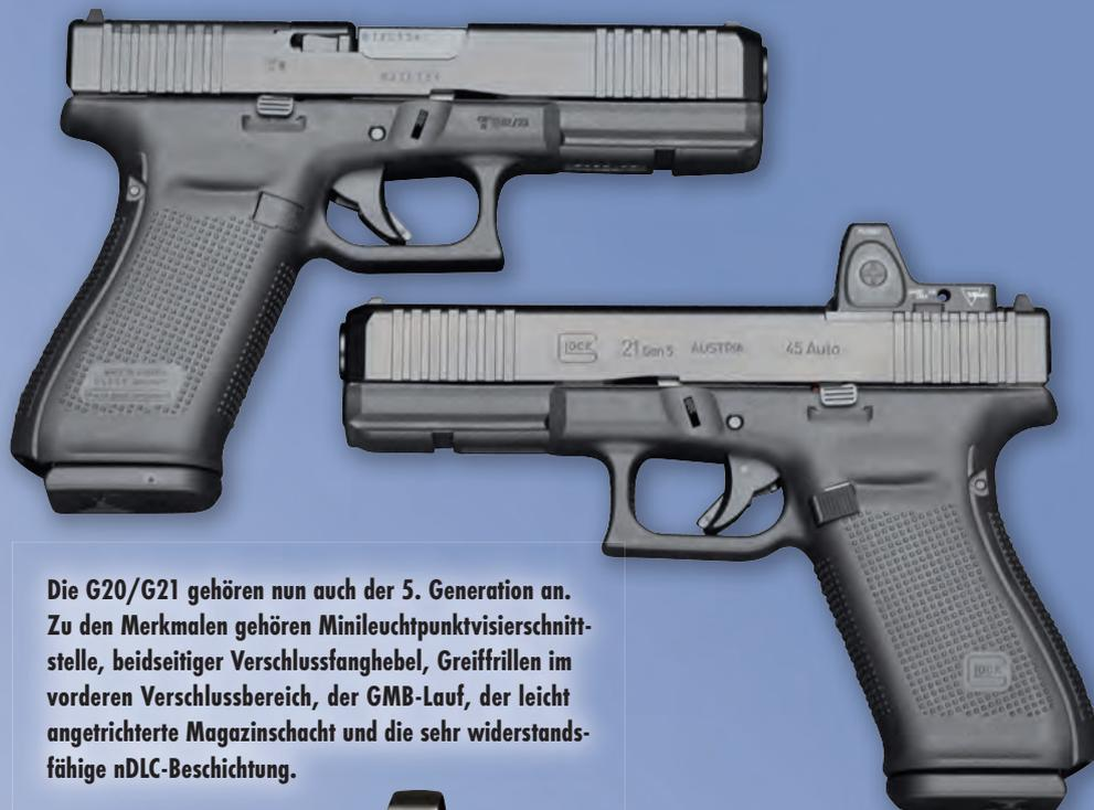
Die G20/G21 gehören nun auch der 5. Generation an. Zu den Merkmalen gehören Minileuchtpunktvisierschnittstelle, beidseitiger Verschlussfanghebel, Greifrippen im vorderen Verschlussbereich, der GMB-Lauf, der leicht angetricherte Magazinschacht und die sehr widerstandsfähige nDLC-Beschichtung.
