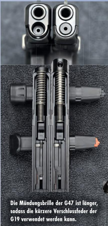
Die Mündungsbrille der G47 ist länger, sodass die kürzere Verschlussfeder der G19 verwendet werden kann.
