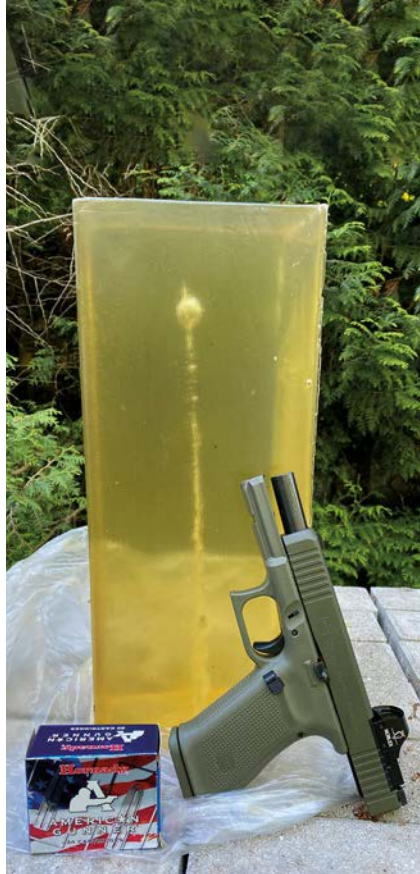
Exemplarisch hier die 155 gr Hornady American Gunner in Clear Ballistics. Trifft mit Energiewerten einer .357 Magnum und bleibt sicher stecken.
