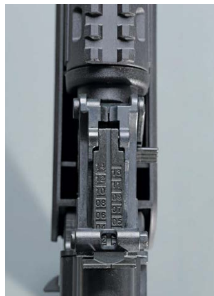
Von Hause kommt die Waffe mit höhenverstellbarer Schiebekimme.
