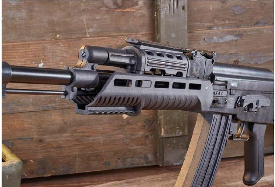
**Großzügig bei Schnittstellen: Auf dem Oberteil des Vorderschafts befindet sich eine Picatinny-Rail, ebenso auf der Unterseite, dazu gibt es seitliche M-Lok-Schlitze.**
