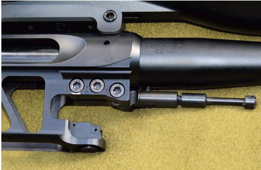
Das skelettierte 505er Stahlgehäuse ähnelt einer Brückenkonstruktion. Auf der Seite sieht man die zu lösenden Schrauben, die die Laufklemmung halten.
