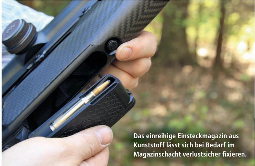
Das einreihige Einsteckmagazin aus Kunststoff lässt sich bei Bedarf im Magazinschacht verlustsicher fixieren.
