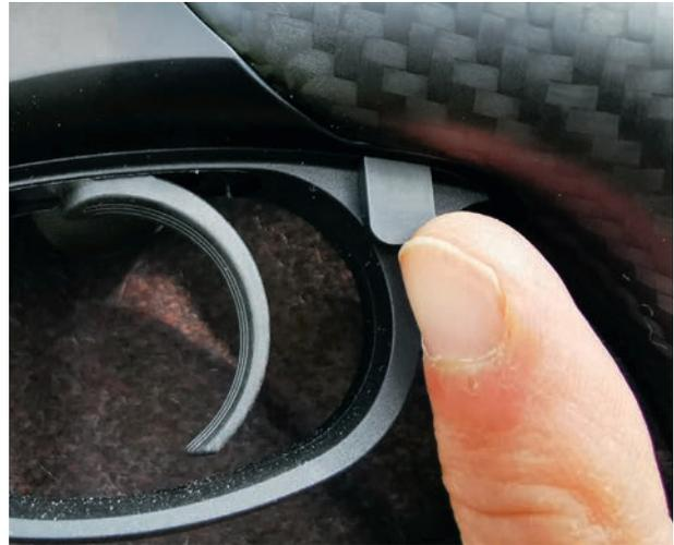
Um den Verschluss aus der Büchse zu entnehmen, muss der kleine Flügel neben dem Abzugsbügel in Richtung Schaft gedrückt werden.
