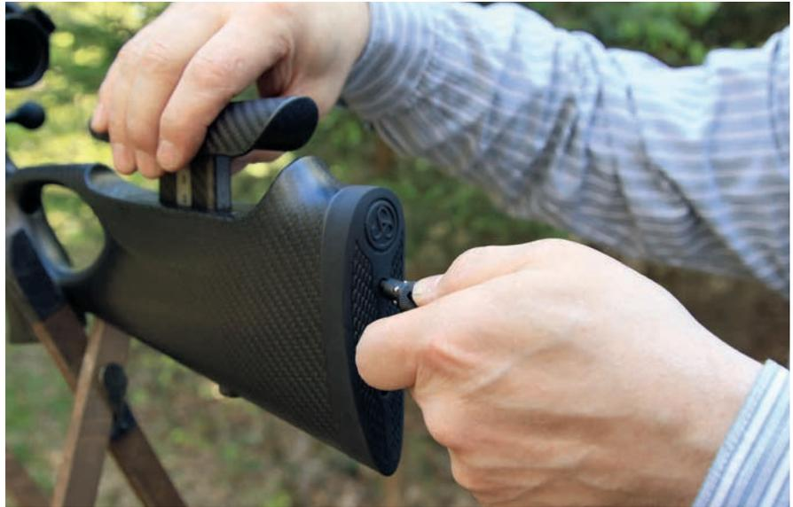
**Von der Schaftjustierung bis zum Laufwechsel lassen sich alle wichtigen Anpassarbeiten mittels des in den Riemenbügel integrierten Schlüssels bewerkstelligen.**
