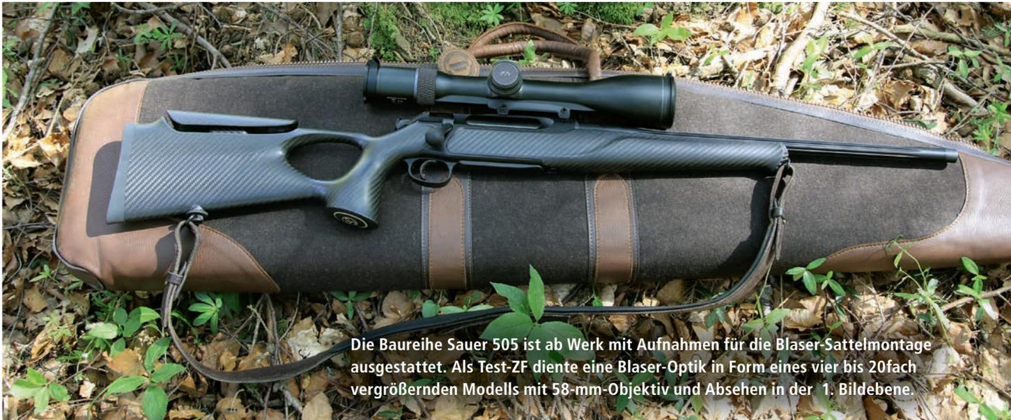
Die Baureihe Sauer 505 ist ab Werk mit Aufnahmen für die Blaser-Sattelmontage ausgestattet. Als Test-ZF diente eine Blaser-Optik in Form eines vier bis 20fach vergrößernden Modells mit 58-mm-Objektiv und Absehen in der 1. Bildebene.
