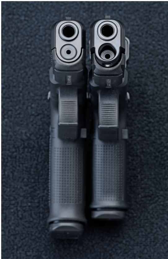
Der Verschluss der G49 basiert auf der G47-Bauweise mit nach hinten verlängerter Mündungsbrille. Somit kommen hier die kürzeren Verschlussfedern der G19 zum Einsatz.
