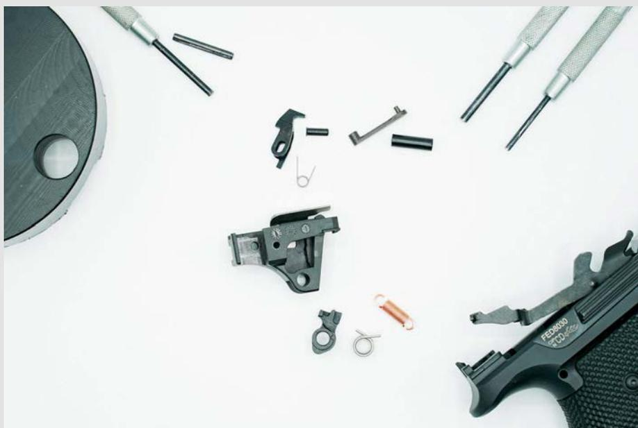
Beim Einbau des Tuningfedersatzes ist handwerkliches Geschick und Kenntnis um die Funktionsweise des Schlagbolzenschlosses notwendig, weil unter anderem das komplette Abzugsgehäuse demontiert werden muss.
