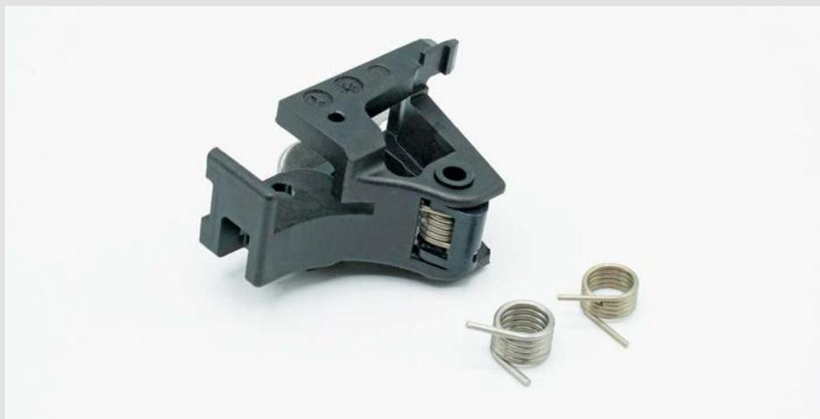
Durch Austausch der unten im Abzugsgehäuse sitzenden Druckpunktfeder wird das Maximum an Abzugsqualität herausgeholt. Achtung: Fertigungsbedingt sind beide Schenkel der Torsionsfeder gleich lang, der nach unten zum Griffstück zeigende Schenkel muss beim Einbau etwas gekürzt werden.
