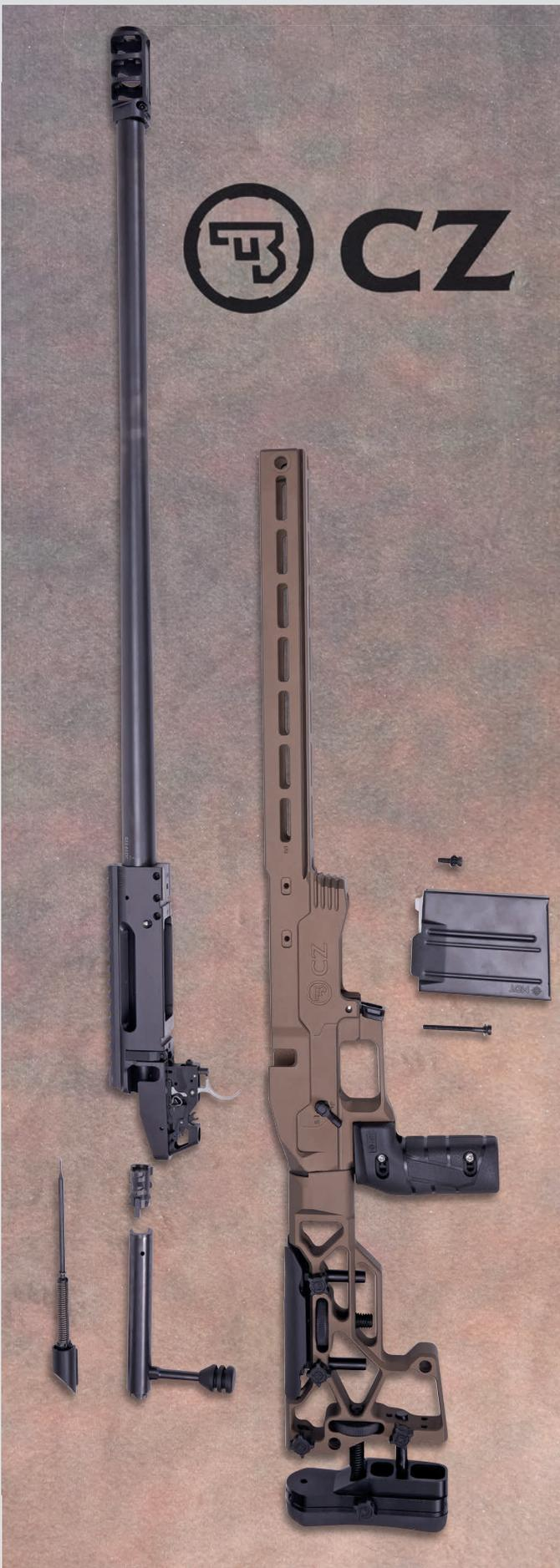
Die demontierte Leichtmetallchassis-PRS/Long-Range-Matchbüchse.
