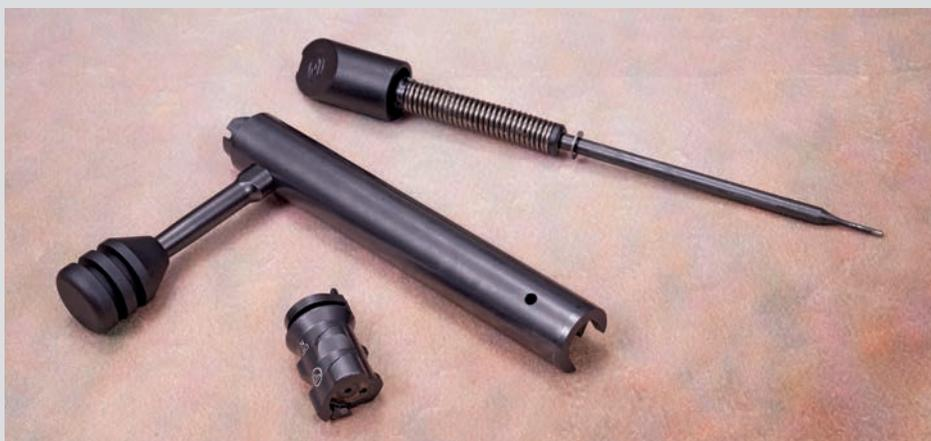
Der Zylinderverschluss mit sechs Riegelwarzen lässt sich leicht demontieren. Interessant: Die doppelte Steuerkurve am Verschlusskammerheck, die für ein sehr leichtes, geschmeidiges Spannen des Schlagbolzens sorgt.
