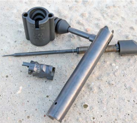
Der Verschluss: Kammer mit Griff, Schlagbolzen mit Feder und Schlösschen sowie Verschlusskopf mit Auszieher. Das zylindrische Teil links ist die Zerlegehilfe.
