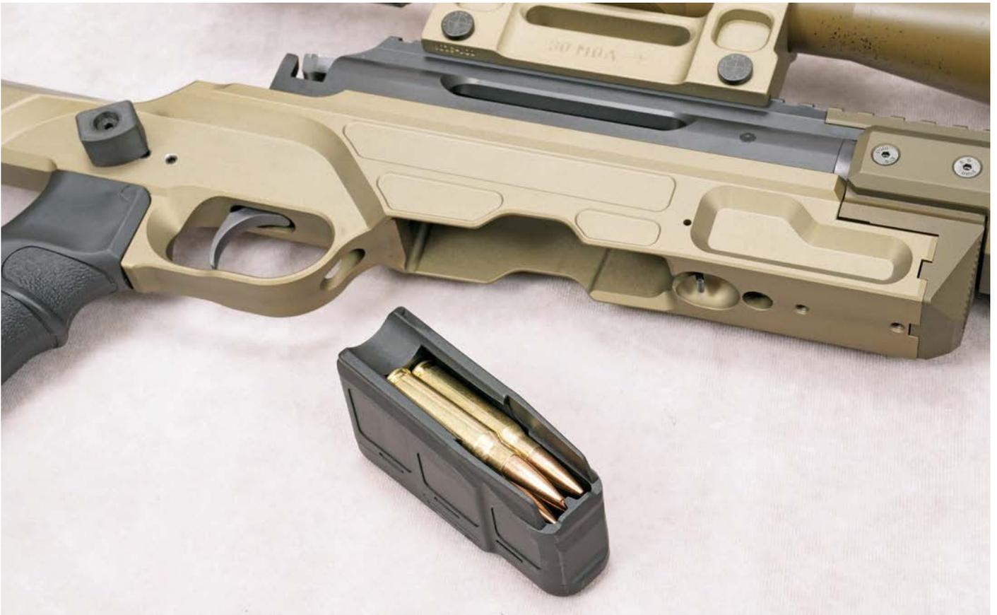
Das Magazin mit Kapazität für fünf Patronen ist mit einer Zubringerfeder mit moderater Federstärke ausgerüstet, was den seidenweichen Repetiervorgang unterstützt.
