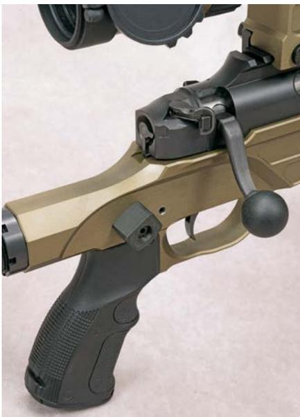
Die serienmäßige Kunststoff-Daumenauflage am Chassis stammt allem Anschein nach aus einem FDM-3D-Drucker.
