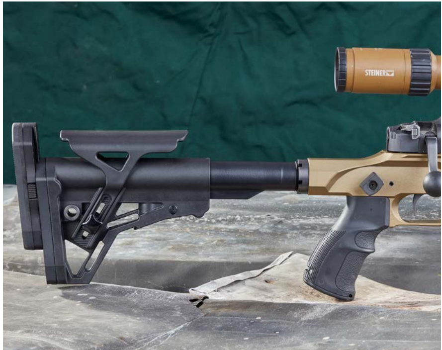
Die Schulterstütze bietet eine Vielzahl von Verstellmöglichkeiten, hier im Bild sind Backe, Kappe und Schaftlänge maximal ausgefahren.
