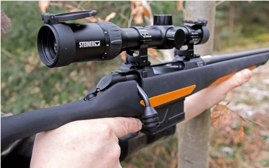
Ist die Waffe gespannt, steht ein roter Pin unter der Schlossmutter hervor. Direkt dahinter befindet sich der Druckknopf der Vertikalsicherung.
