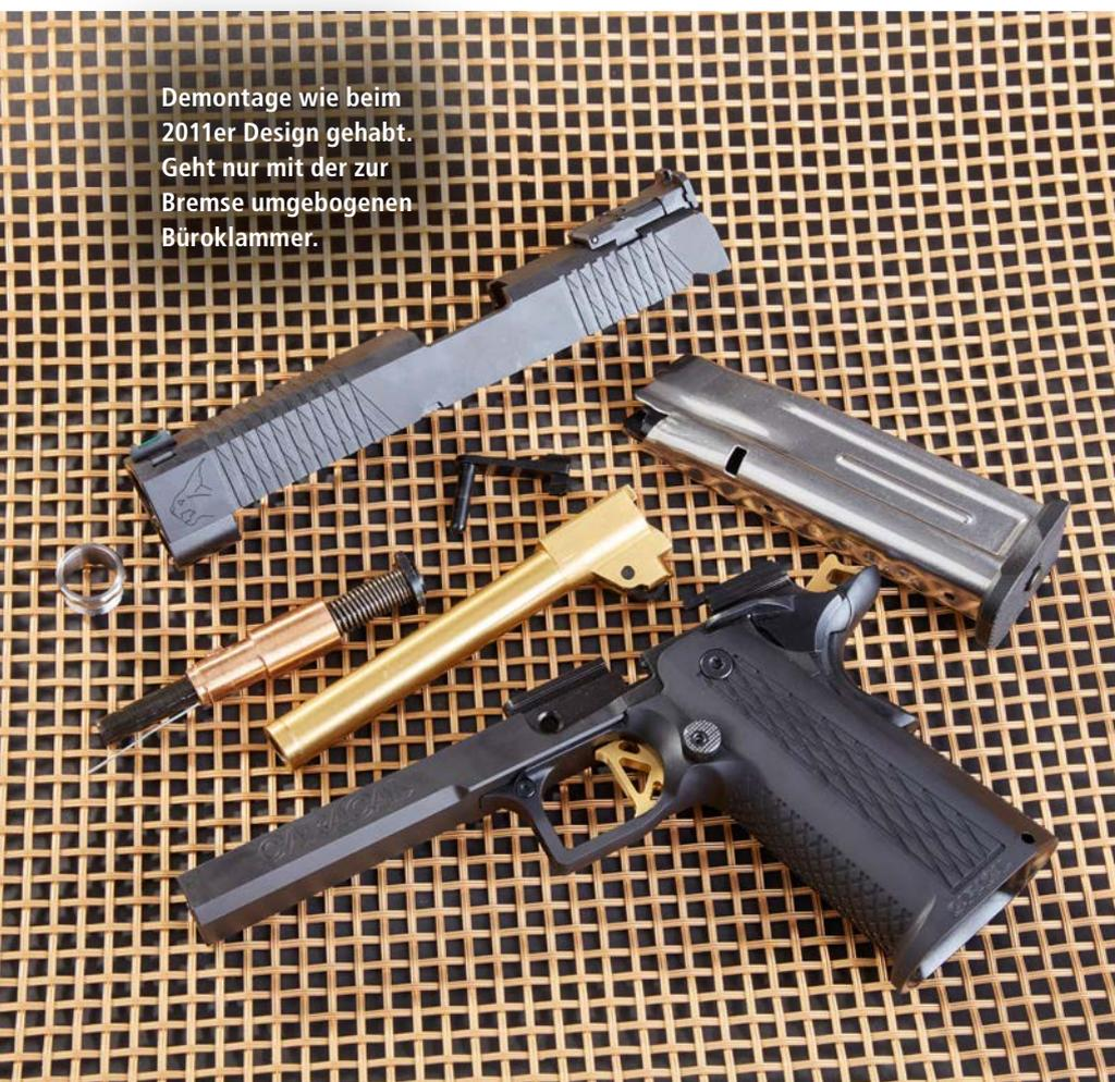
Demontage wie beim 2011er Design gehabt. Geht nur mit der zur Bremse umgebogenen Büroklammer.
