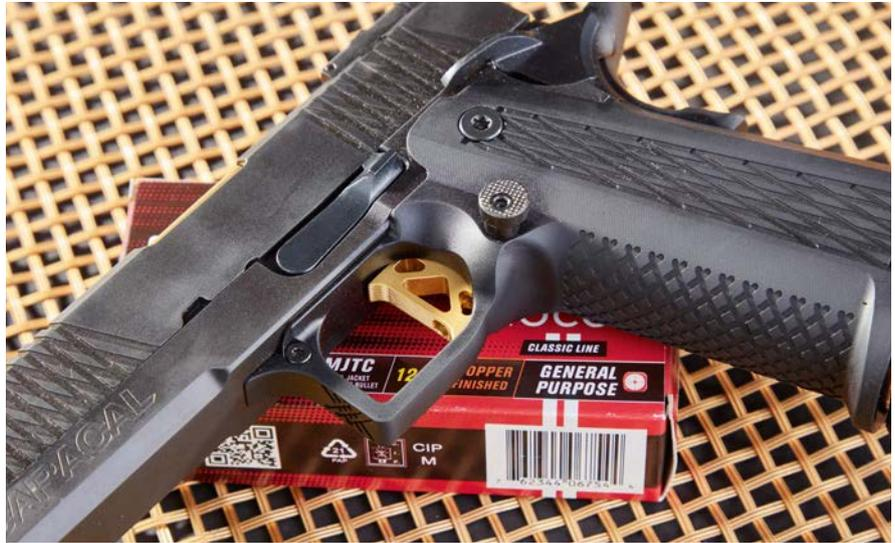
Der Abzug der Lynx ist optisch nett gestaltet und mit einem Triggerstop versehen. Die asymmetrische Bohrung durch die Magazin-Auslösetaste erlaubt, diese in eine für den Daumen optimale Position „näher dran oder weiter weg“ zu drehen.
