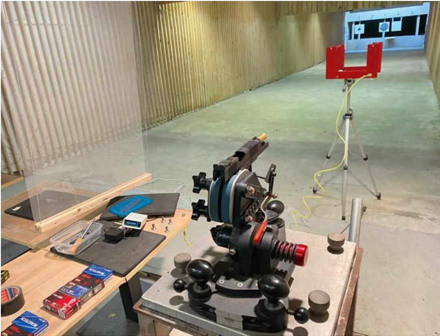
Auch aus der Schießmaschine gab es keinen Grund zum Meckern. Die Lynx hält mit fast jeder 9 mm-Laborierung die 10, sogar mit einigen sehr günstigen Marken.
