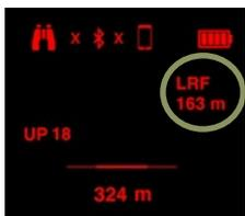
Der Höhenturm des eRanger 8 kann nun entsprechend verstellt werden, bis die gemessene Distanz und ballistische Distanz übereinstimmt. 163m wird im Display angezeigt.
