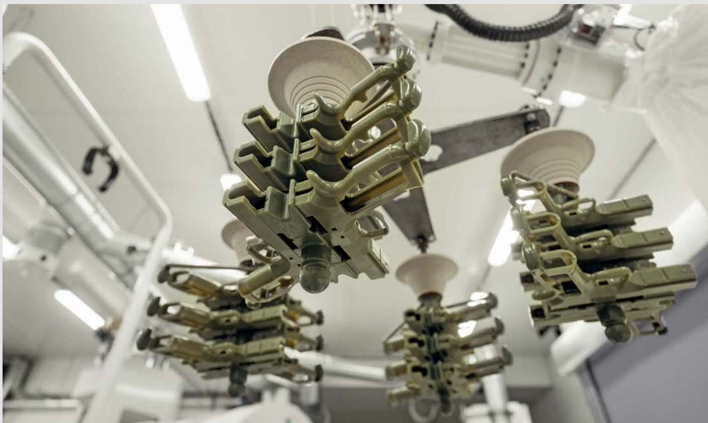
CZ beherrscht die kostengünstige Fertigung mittels Wachsaußschmelzverfahren. Die Rohlinge aus grünem Wachs hängen hier gleich zu sechst an einem Strang (Wachstraube). Nach dem Schlickern und Besanden in sich wiederholenden Arbeitsgängen und dem Ausschmelzen des Waxes entsteht daraus die Gussform. (Foto: CZ)
