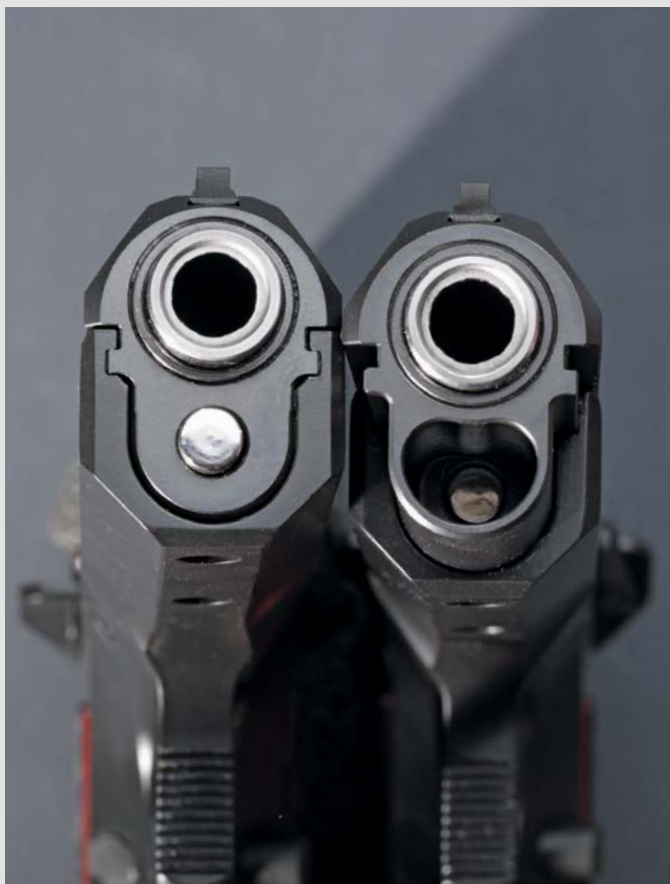
Von vorne wird die markante dreieckige Form des Verschlusses richtig deutlich. Die Laufmündung ist zum Schutz gegen Beschädigungen hinterdreht.
