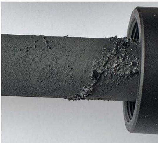
Der verschmutzte Schalldämpfer nach über 200 Schuss im Detail: Laufhaltemutter, Lamelleninnenleben und Mündungsbe- reich der Flüstertüte.
