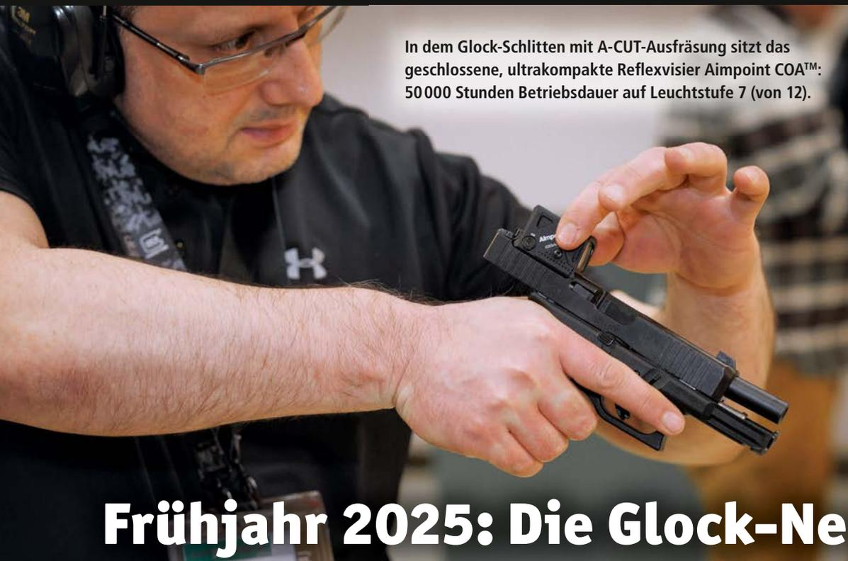
In dem Glock-Schlitten mit A-CUT-Ausfräsung sitzt das geschlossene, ultrakompakte Reflexvisier Aimpoint COA™: 50 000 Stunden Betriebsdauer auf Leuchtstufe 7 (von 12).
