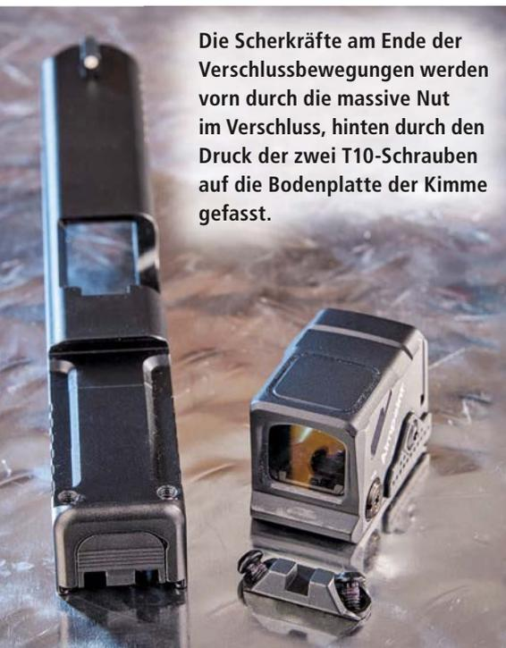
Die Scherkräfte am Ende der Verschlussbewegungen werden vorn durch die massive Nut im Verschluss, hinten durch den Druck der zwei T10-Schrauben auf die Bodenplatte der Kimme gefasst.
