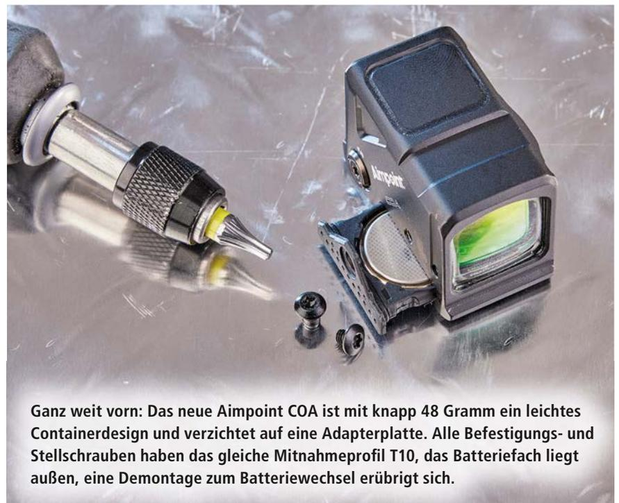
Ganz weit vorn: Das neue Aimpoint COA ist mit knapp 48 Gramm ein leichtes Containerdesign und verzichtet auf eine Adapterplatte. Alle Befestigungs- und Stellschrauben haben das gleiche Mitnahmeprofil T10, das Batteriefach liegt außen, eine Demontage zum Batteriewechsel erübrigt sich.
