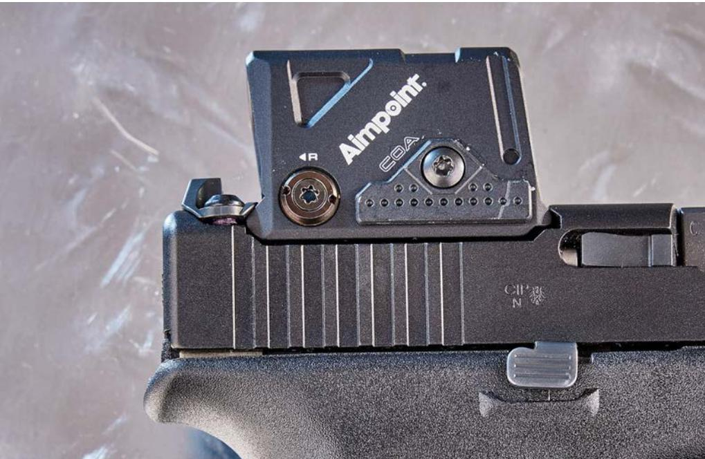
Die vordere Nase am Korpus des Aimpoint COA greift mündungsseitig in eine Nut am Verschluss, die hintere Fläche wird von der Bodenplatte der Kimme gefasst.
